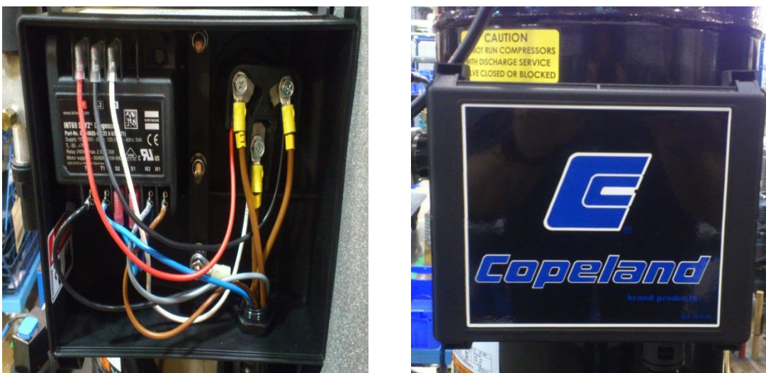
Figura 15: Montajul electric corect cu presetupă pentru cutia de borne IP54 (model ZF33KVE)
