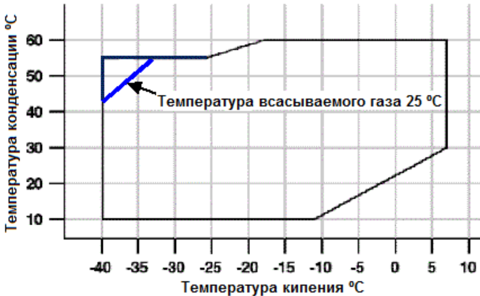
Рис. 5: Рабочий диапазон спиральных компрессоров с впрыском пара, R404A
