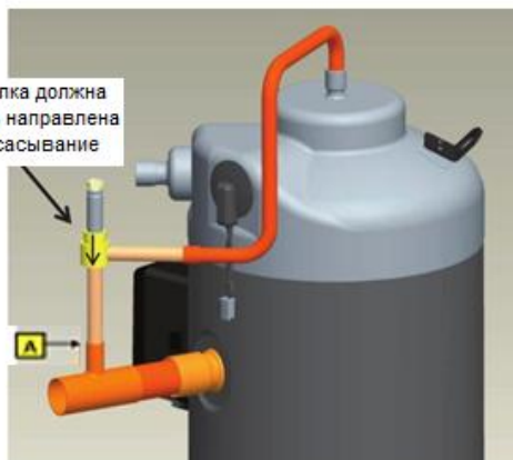
Рис. 8: Размещение электромагнитного клапана Рис. 9: Рекомендуемая трубная обвязка клапана
