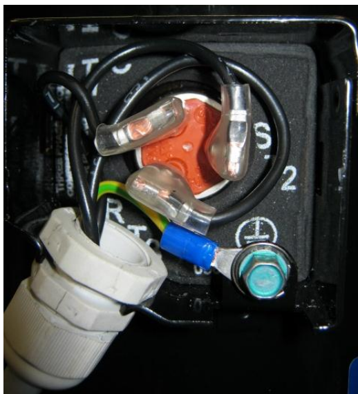
Рис. 19: Пример правильного подключения ZBD21K* и ZBD29k* с помощью кабельной муфты
