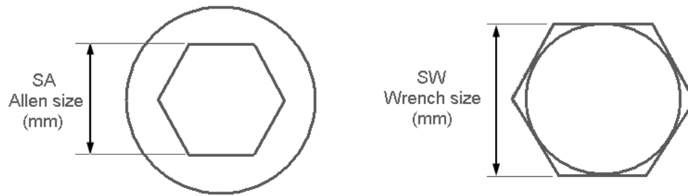
Figure 45 : Vis à douille hexagonale (Allen/Inbus) & têtes hexagonales (clé/wrench)
