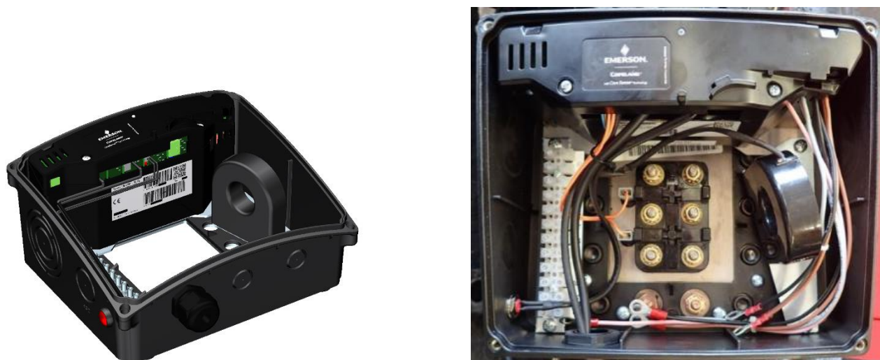
Rysunek 6: Puszka zaciskowa z modułem Copeland compressor electronics
