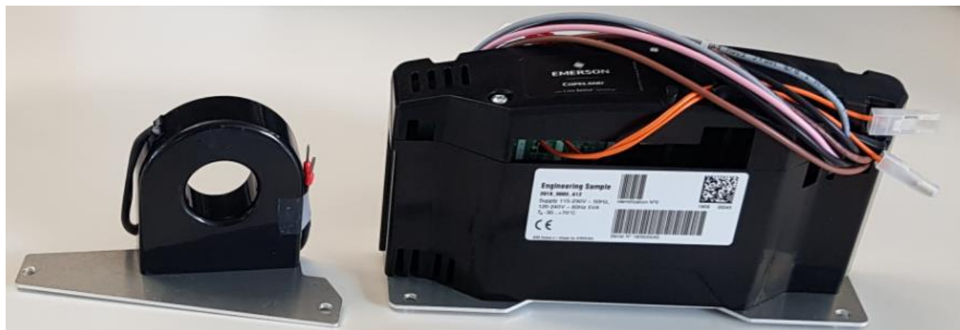
Rysunek 5: Czujnik prądu i moduł Copeland compressor electronics
