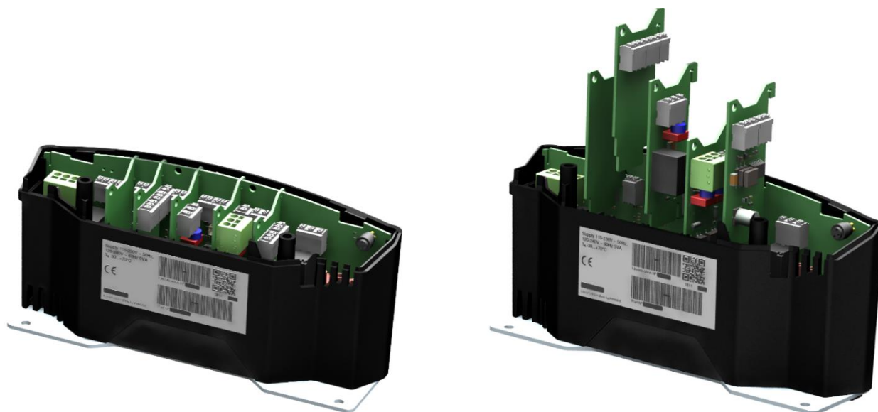
Figure 3 : Vue intérieure du module Copeland compressor electronics et de ses modules d'extension
