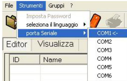
**NOTA:** *è possibile la lettura e/o scrittura dei parametri solamente per quei controllori dotati di porta di comunicazione seriale RS485 o TTL. Per gli strumenti non forniti di porta seriale (serie PRIME e WING BASIC) è possibile solamente la creazione di HOT KEY con cui poi programmare i dispositivi*
