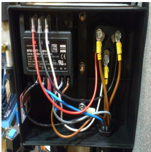
Rysunek 15: Prawidłowe podłączenie skrzynki IP54 z wykorzystaniem dławika (modele TW*)
