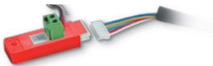
Le XJ485CX est un convertisseur externe TTL/RS485. Insérer le dans le connecteur TTL pour convertir la sortie TTL en signal RS485 (+) et (-) pour la compatibilité avec les systèmes de supervision (XWEB) compatibles MODBUS\_RTU.
