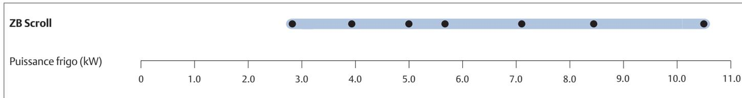
EN12900, Evaporation -10°C, Condensation 45°C, Surchauffe 10K, Sous-refroidissement 0K
